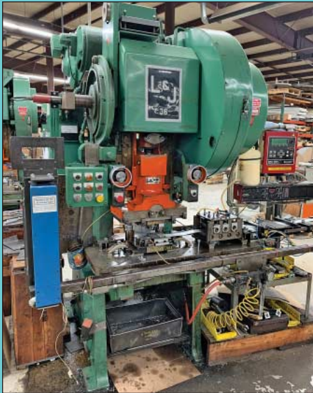
36 Ton L&J Flywheel Type OBI Press
